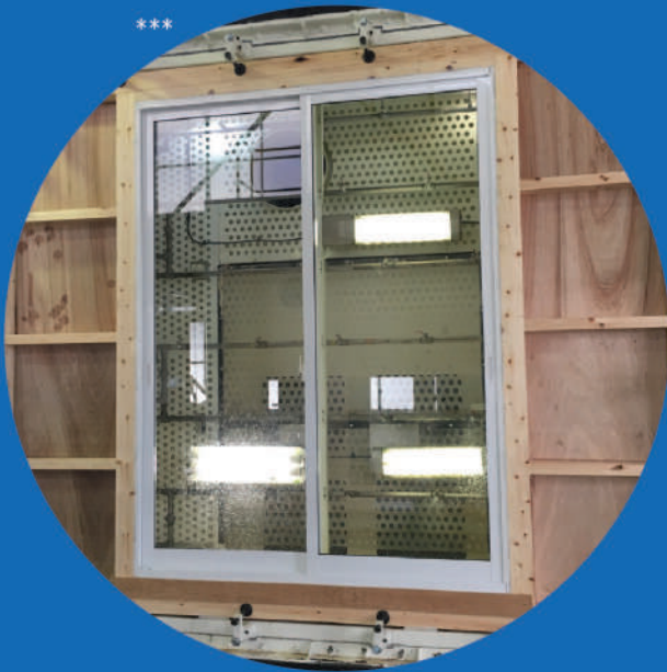
*** รูปการทดสอบ water tightness ของบาน JTrust ที่ประเทศญี่ปุ่น
